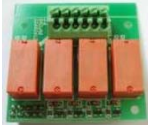
Relay module PCB - PK1
